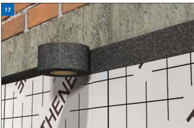
*(Рис. 17)* При использовании ленты DELTA®-FLEXX-BAND минеральные поверхности обработать грунтовкой DELTA®-THENE-GRUNDANSTRICH и дать высохнуть. Применение планок или цокольных шин также возможно, они должны быть установлены сразу после наклейки мембраны DELTA®-THENE.
