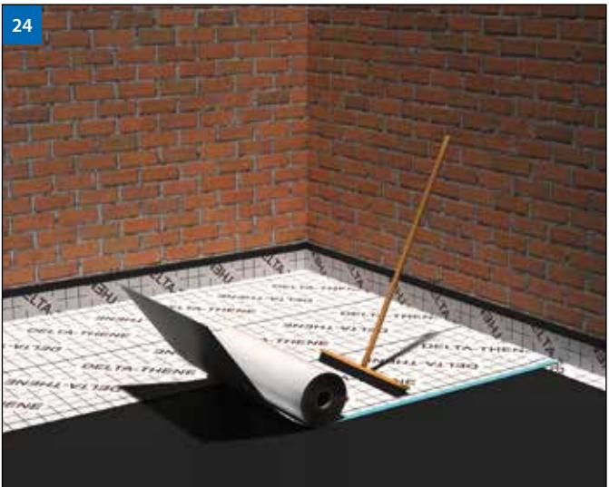
(Рис. 24) Следующий рулон уложить с нахлестом 10 см. Удалить с нижнего рулона защитную синюю полосу и проклеить зону нахлеста рулонов.
