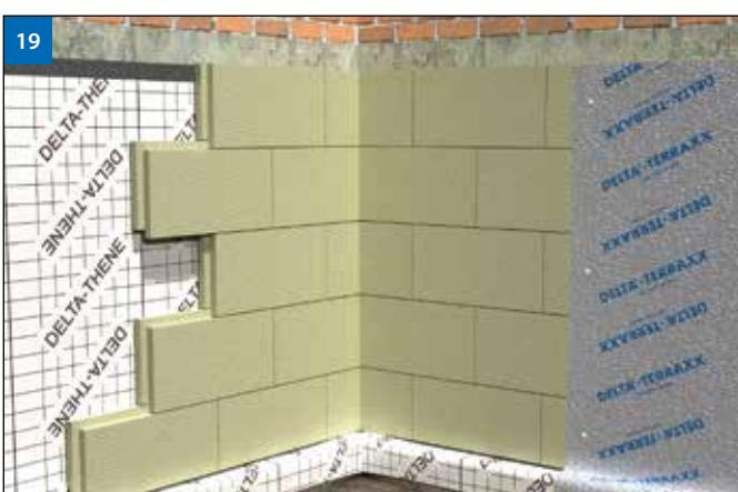
(Рис. 19) Установка дополнительной теплоизоляции также возможна. Утеплитель наклеить на гидроизоляционную мембрану DELTA®-THENE с помощью холодной мастики (без растворителя) или специального клея. После на теплоизоляцию уложить дренажную мембрану DELTA®-TERRAXX и закрепить с помощью пластиковых шурупов DELTA®-TERRAXX-SCHRAUBE (расход примерно 1 шт./кв.м).
