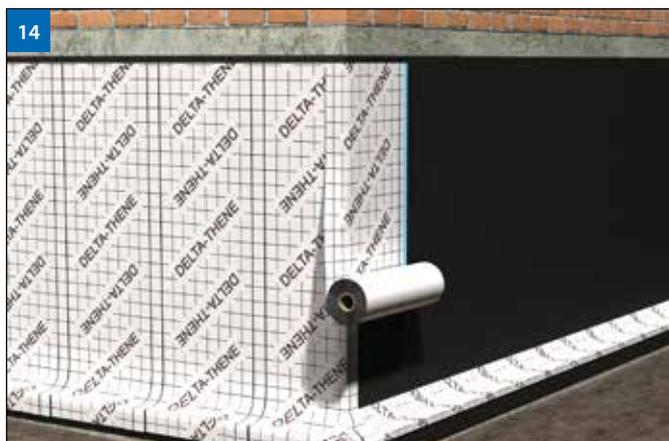
(Рис. 14) Для внешних углов сначала наклеить усиливающие полосы шириной 30 см на угол или в качестве альтернативного решения завести мембрану на 15 см вокруг угла с обеих сторон для формирования двух слоёв гидроизоляции.
