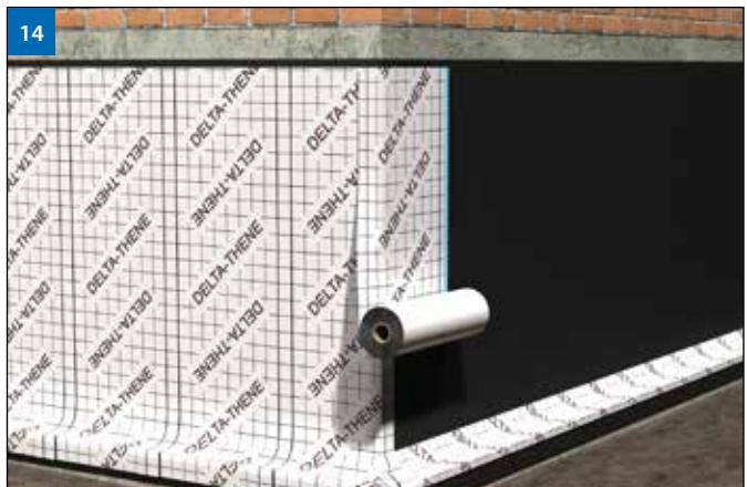
(Рис. 14) Для внешних углов сначала наклеить усиливающие полосы шириной 30 см на угол или в качестве альтернативного решения завести мембрану на 15 см вокруг угла с обеих сторон для формирования двух слоёв гидроизоляции.
