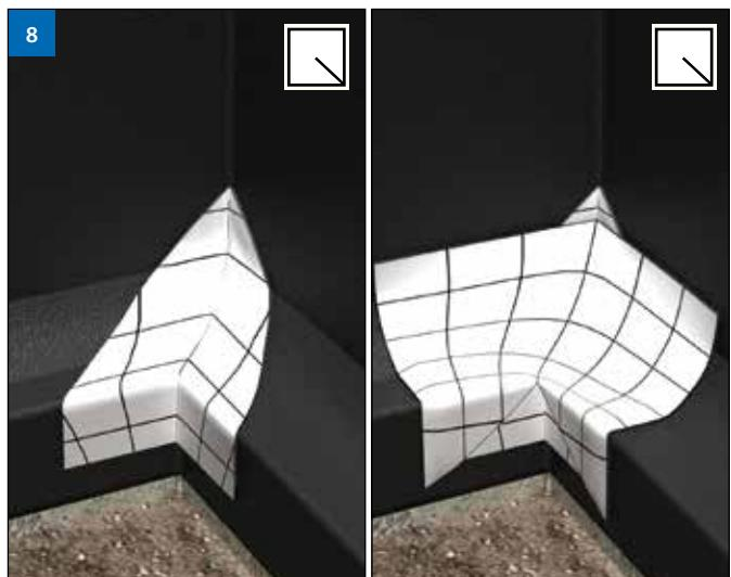
(Рис. 8) Для внутренних углов подготовить квадратный кусок размером около 30 x 30 см и прорезать от середины до вершины. Далее сформировать треугольную заготовку в виде угла и наклеить на галтель. Затем вырезать квадратную заготовку от угла до середины и сверху наклеить в угол на первую заготовку.
