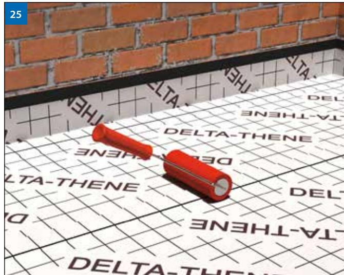
(Рис. 25) Все нахлесты, примыкания и проходки тщательно прокатать роликом, не допуская образования воздушных полостей и пузырей.
