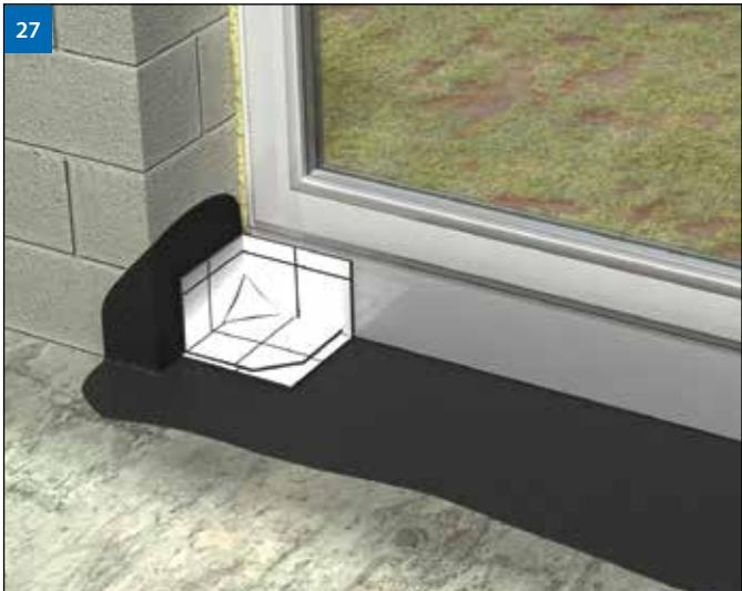
(Рис. 27) Сначала следует очистить основание и тщательно его загрунтовать. После просушки подготовить квадратный кусок DELTA®-THENЕ, разрезать от середины до одного края и отрезать угловой треугольной кусок примерно 5x5 см. Склейте заготовку в форме угловой фасонной детали (внутренний угол) и установить по месту. Треугольной кусок наклеить в середине заготовки в качестве дополнительной защиты.
